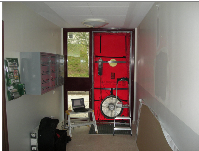
Bild 2. Blower Door placeras i entrépartiets dörröppning.
