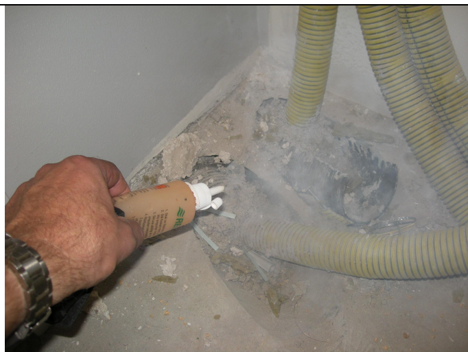
Bild 8. Läcksökning med indikeringsrök. Trapphuset är undertryck men själva tryckserien för tätetsprovningen har inte påbörjats.
